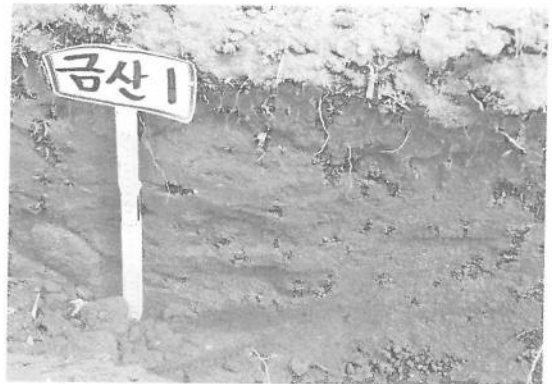
그림 14. 논을 포지로 사용하여 불투수층 형성 (충남 금산 남이 흑암리)
