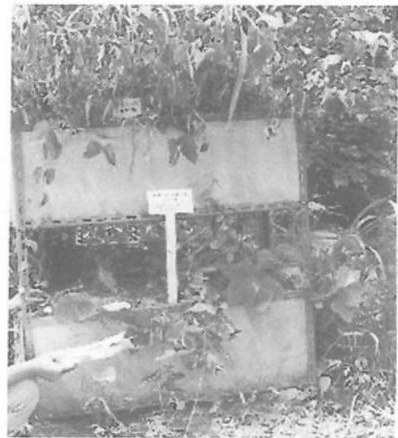
사진 2003년 시험처리한 벽면걸이 녹화시험구 전경(2003. 7. 14) 사진 왼쪽은 북동향, 그림 오른쪽은 남서향 시험구의 식생 성장상황으로 건조현상으로 식생이 시들어 보이고 있으며 이 시험구 역시 식재상 하층에 비해 상층에서 침입종이 무성하게 자라고있다.
