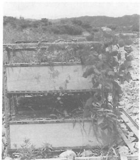
사진 2002 시험 처리한 벽면걸이 녹화시험구 식생 성장상황(2003. 7. 14) 왼쪽 사진은 북서향 시험구, 오른쪽은 남동향 시험구의 전경, 식재상의 상층은 하층에 비해 두 시험구 공히 침입종이 무성하게 자라고 있으며 식생이 건조로 시들어 보이고 있다.
