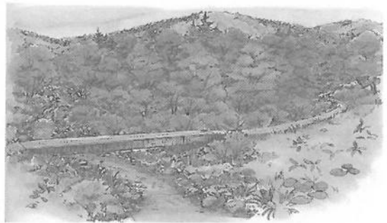
그림 3. 수변지역에 있어서 도로개설의 유의점 이며, 이는 수생생태계의 산란장이 되는 사력을 매우기 때문에 붕괴토사보다 나쁜 영향을 미치는 경우가 있다.
